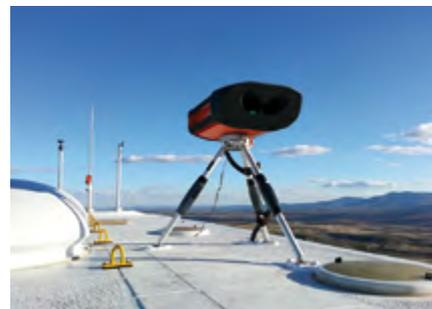
Capteur Lidar sur une nacelle : Wind Iris d'Avent Lidar Technology.
